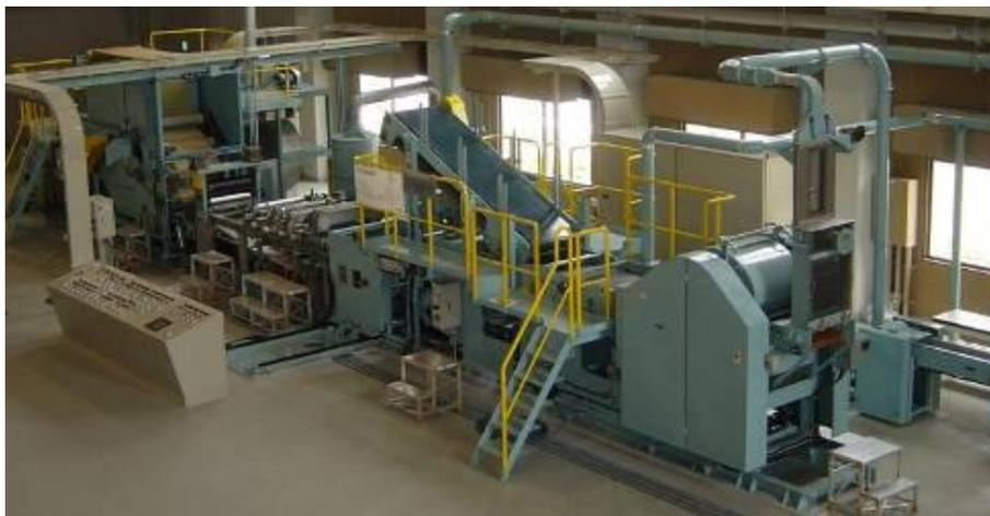
写真2 多目的不織布製造装置
