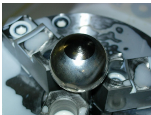
図 1-20. 機上ポリシングツールによる骨頭加工
