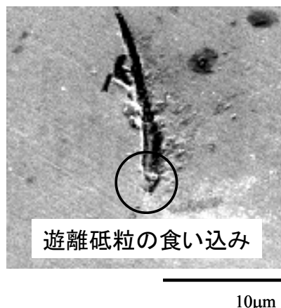
図 1-1. 研磨面への遊離砥粒の食い込み
