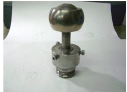
図 3 7 治具写真 両サイドでサンドして保持
