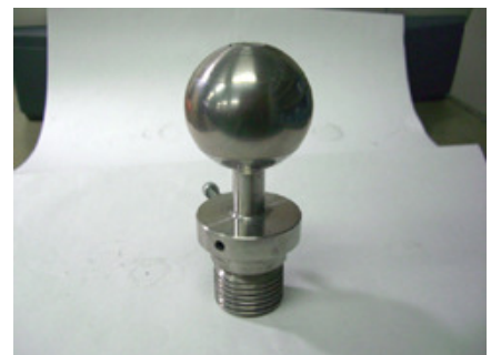
図 3 8 治具写真 球体になる様に 治具で挟み込んで保持
