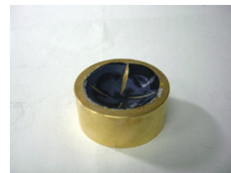
図40 治具…同Rの皿にパッドを貼り付け
