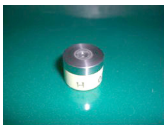
①円筒の砥石を保持させ その上にカンザシ受けを 付けたもの
