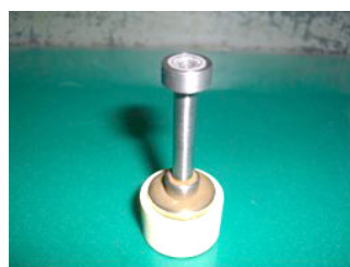
②円筒の砥石を保持させ その上に軸を延ばして カンザシ受けを付けたもの
