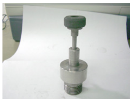
図 3 1 検証した円柱状の砥石(左) と 考案した砥石を保持する治具(右)
