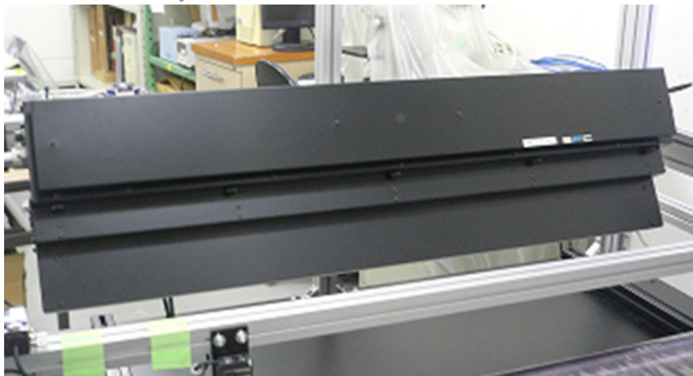
図 4 開発したハロゲンライン照明
