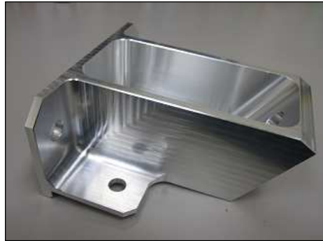
図17：検証モデル3の実加工結果 取残し無く、良好な仕上がり。
