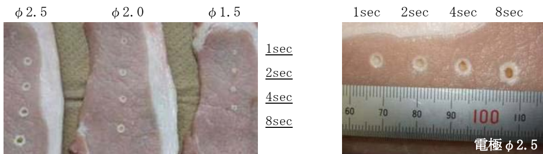
通電実験後の豚ロース肉
