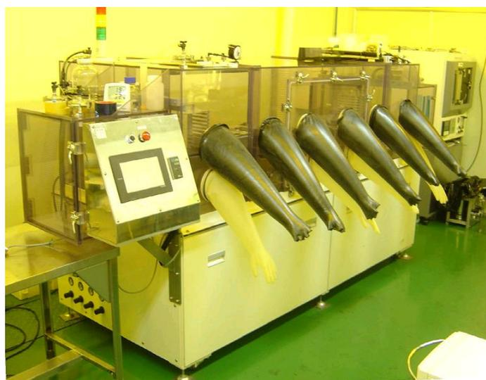
図 1. グローブボックス式塗布装置
