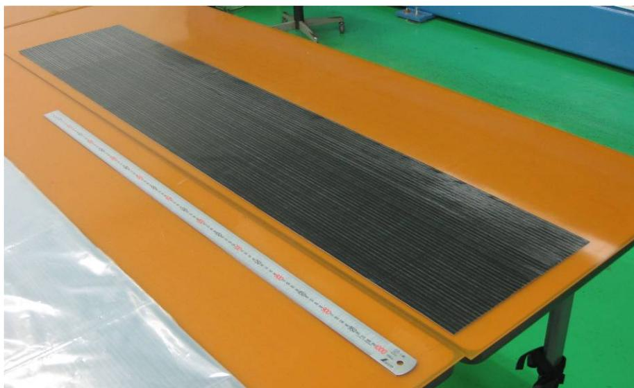
写真 4-1-1-1 平成 23 年度試作プリプレグ材料の外観
