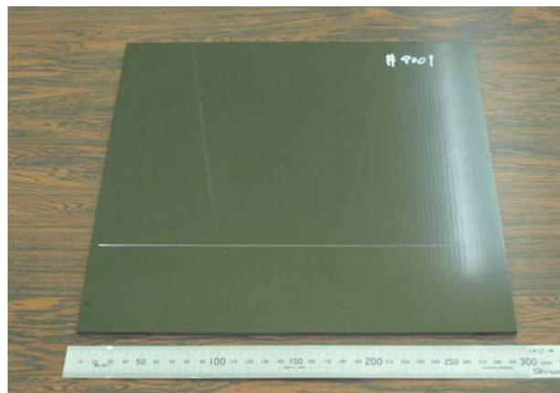
図 4-1-3-2 SiC-CNT 添加プリプレグ材料による積層板の外観
