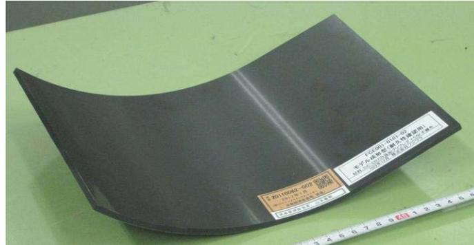
図 4-1-4-3 CNF 積層板の外観
