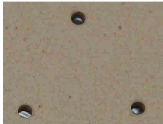
セラミック噴出体 (拡大) (噴出口径：3.2mm)
