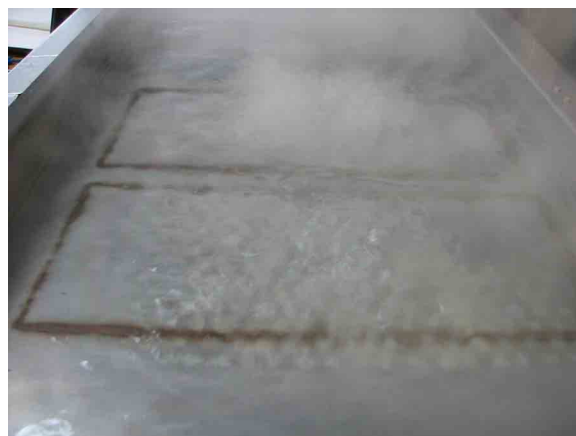
図 7-2 排気噴流衝突部の沸騰の様子
