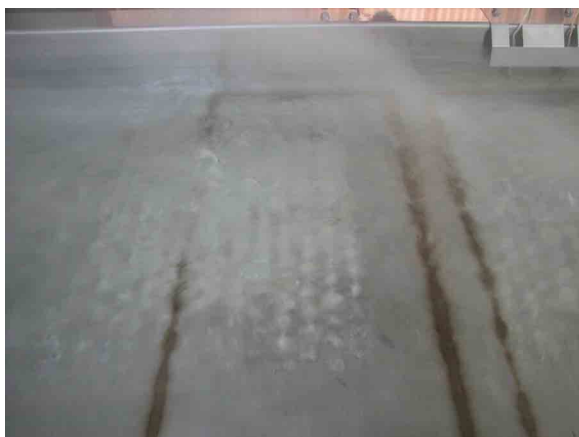
図 7-2 排気噴流衝突部の沸騰の様子
