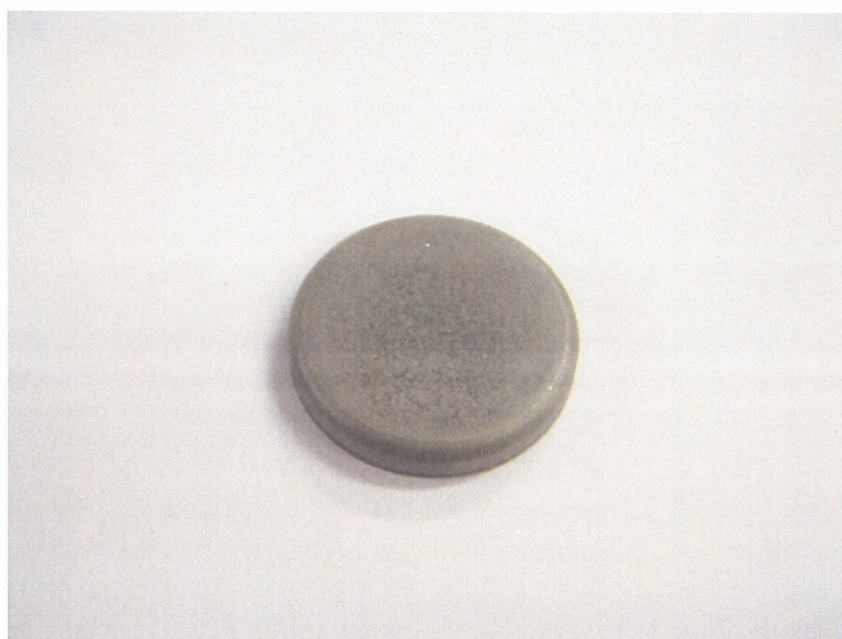
図 2. 2. 2. 1 プラズマ窒化したA 2 0 1 1 材部品。外観ではほぼ均一に黒色の窒化層が表面に形成されていることがわかる。
