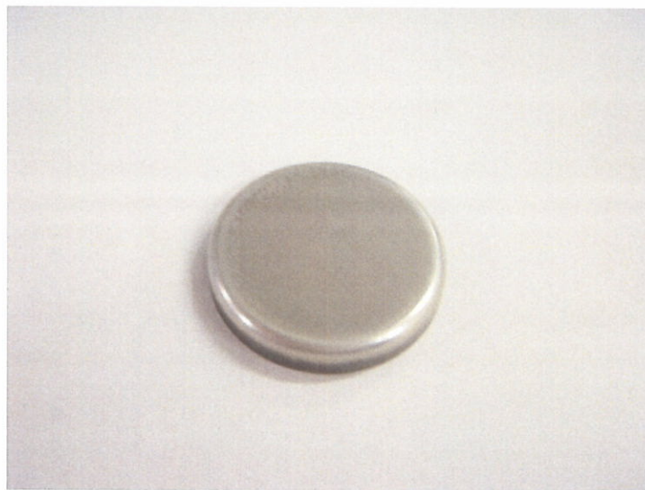
図 2.4.2 低温プラズマ窒化したA2014 材部品の外観。 やや薄い黒緑色であるが、図 2. 1 3 に比較して窒化層が十分に厚い。
