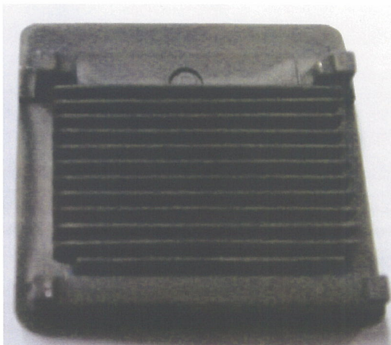
図 2.5.1 プラズマ窒化した A2014 材ヒートシンク
