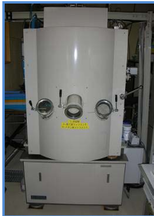
図4-2 イオンビームアシスト蒸着の概念図と真空蒸着装置外観
