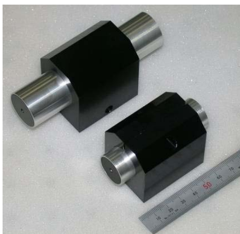
図2-6 結晶Bを使った偏光依存型光アイソレータ (手前側。奥はTGGを使った試作品)
