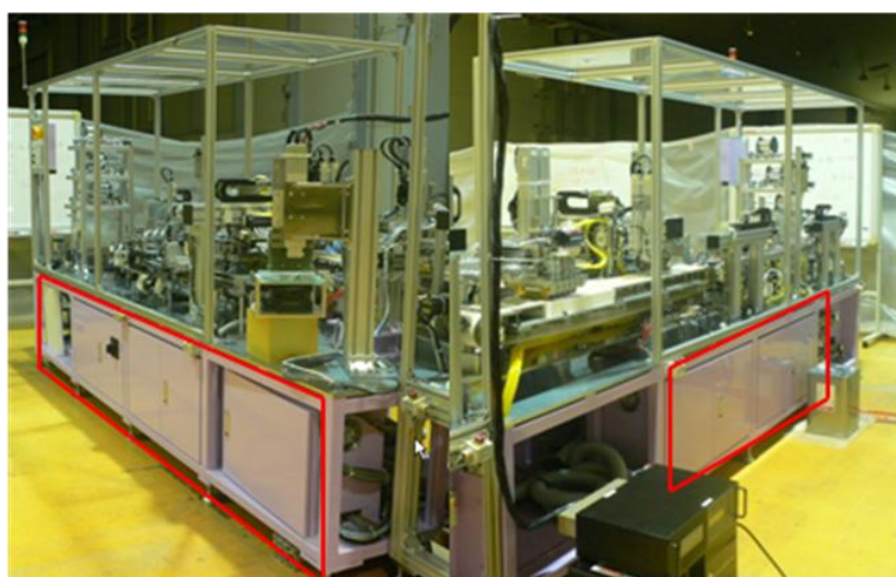
図 9：製造装置（赤枠内は電気制御ユニット）
