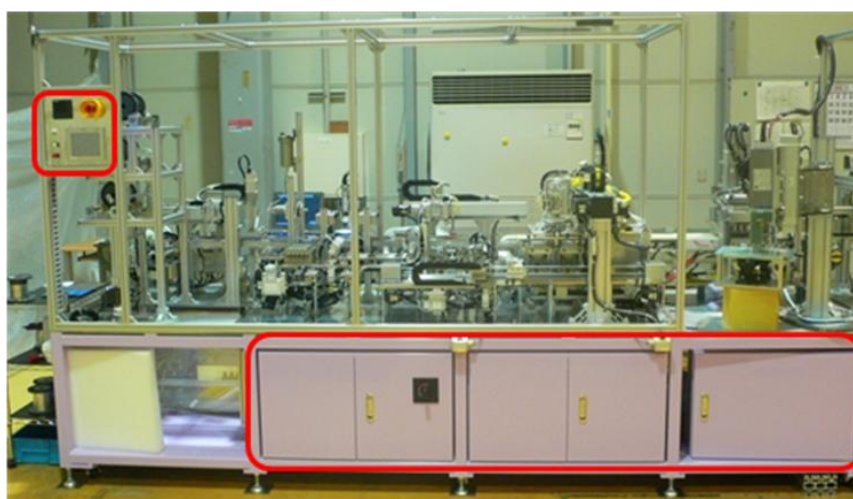
図 8：製造装置全体（赤枠内は電気制御ユニット）
