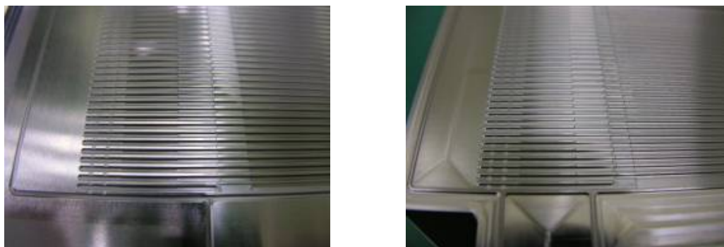
図2-3-2 カソード成形部品（左：ダイス、右：パンチ）
