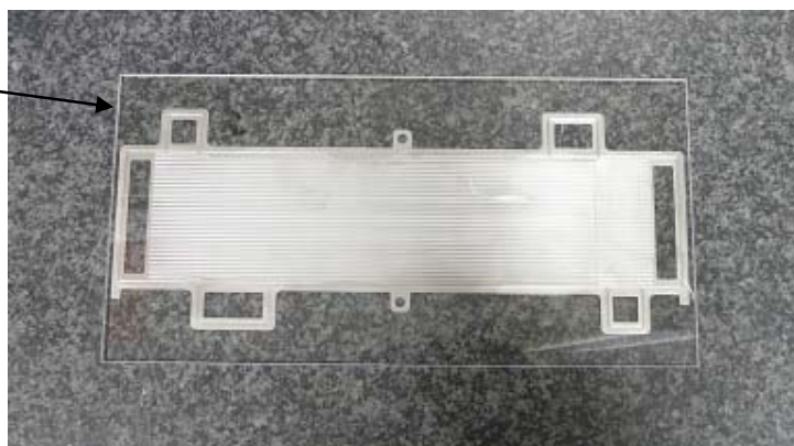
図3-4-1 セパレータとガラス板（カソード極の例）
