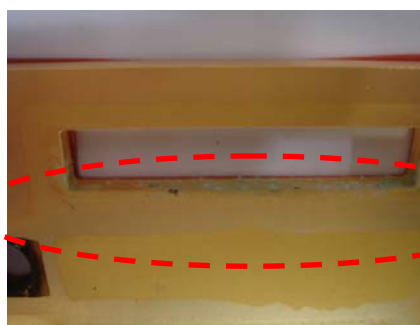
図6-5-1-6. カソード側集電板
