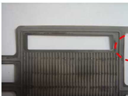
図6-5-1-5. カソードセパレータ外観
