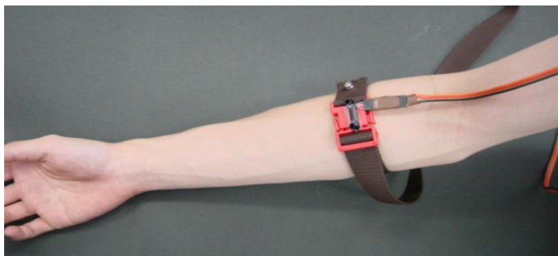
図 2-21 ねじり検出機構
