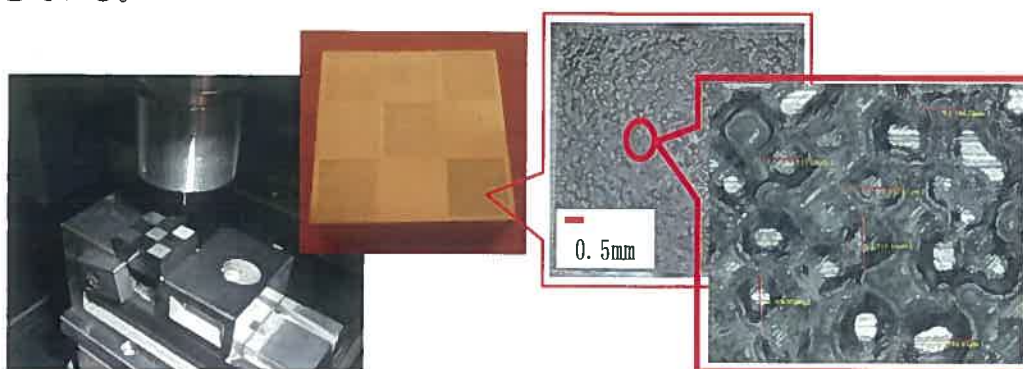
図 2-7 100 \mu\text{m} 相当サイズの切削シボの事例
