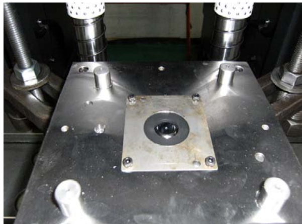
図 2.4.5 絞り加工下型の写真
