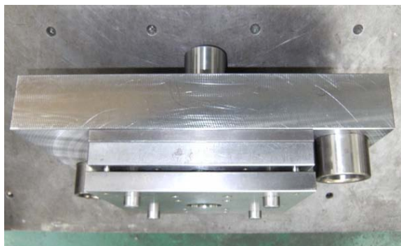
図 2.4.1 せん断加工上型の写真
