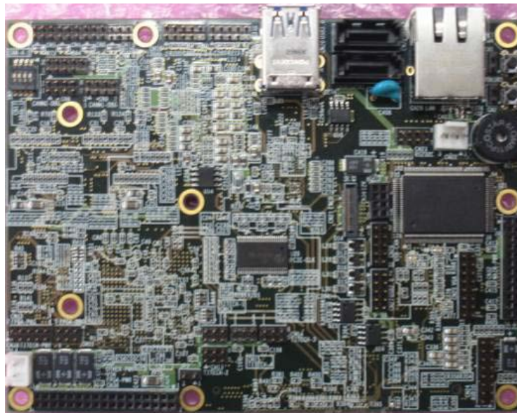
図 2-2-2-1 開発した PC 制御基板 (COM Express キャリアボード) の外観 (95mm x 125mm)
