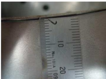
図 4-3-2 突合せ部測定写真
