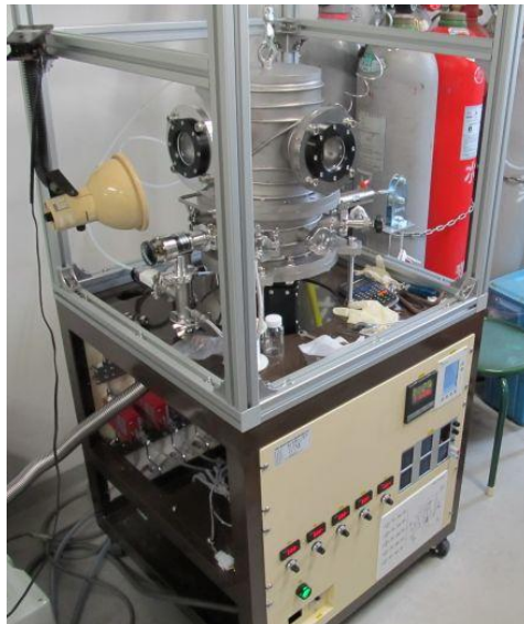
図 3-5 熱フィラメント CVD 装置全景
