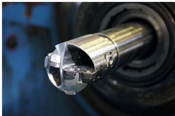
図28 3軸加速度計内蔵刃先交換式ドリルヘッド（中間刃内蔵型）
