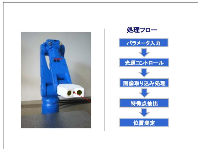
図5 0 実用化に近い計測ロボットへの適用
