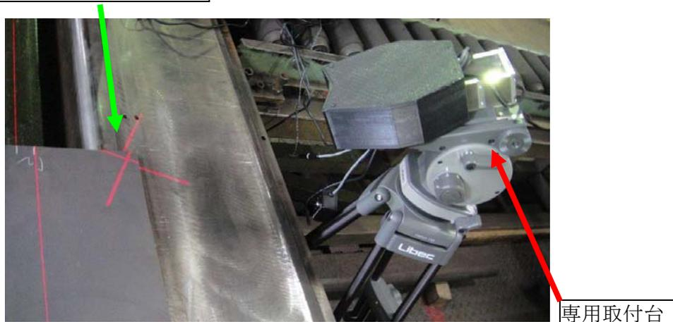
図45 鋼板位置測定装置（クロスラインレーザーの例）
