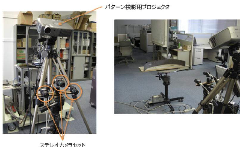
図3-3 撮像装置および撮像風景
