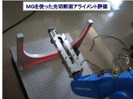
図 2 1 マスタゲージ上の光切断線
