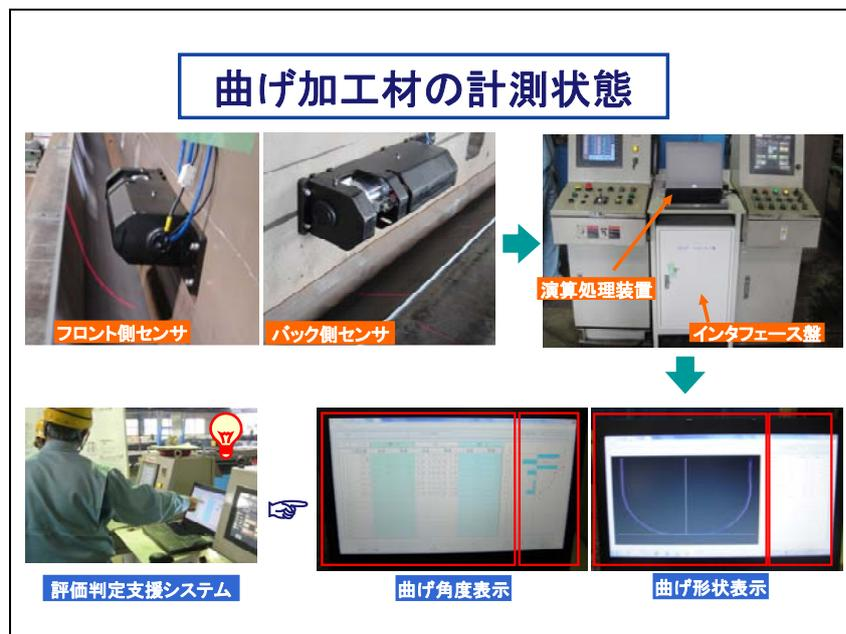
図81 1500tプレスに設置の開発センサとUI
