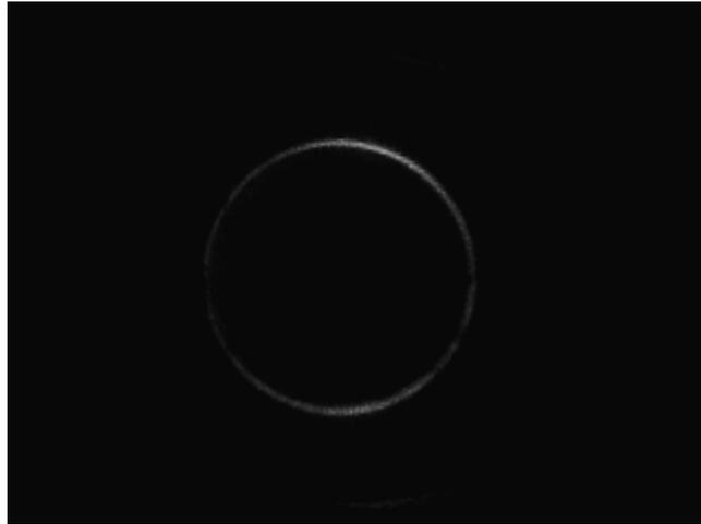
図 8 半導体レーザーを使用したときに生じる光強度ムラの存在
