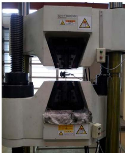
(a) 万能試験機 (油圧式 100ton)
