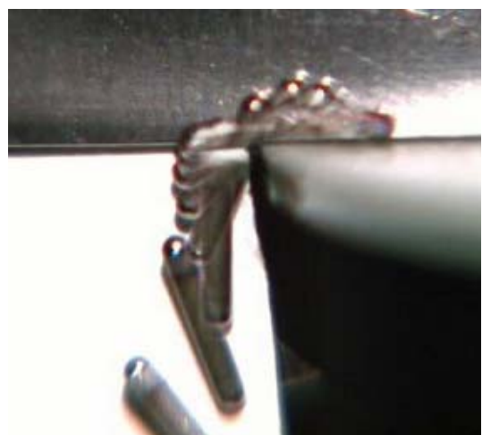
図 C-W6 回転テーブル端からシュートに落下するシード
