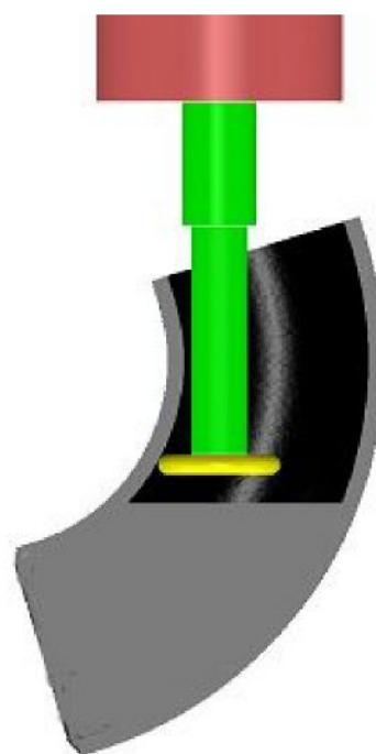
④ 1面側の特殊カッターによる 仕上加工
