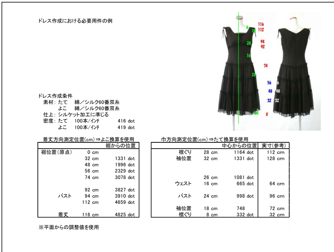
Fig3.3.1.1.3.1 ドット換算表を使ってシルケット加工に適応した数値を割り出した例
