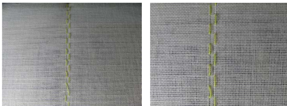
Fig.2.2.2.1.2 新たなスワイベル装置によるスワイベル織
