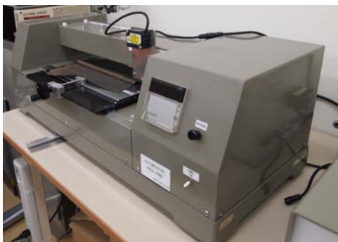
Fig. 3.3.2.6 シームパッカリング測定装置
