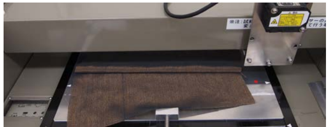
Fig. 3.3.2.6 シームパッカリング測定装置
