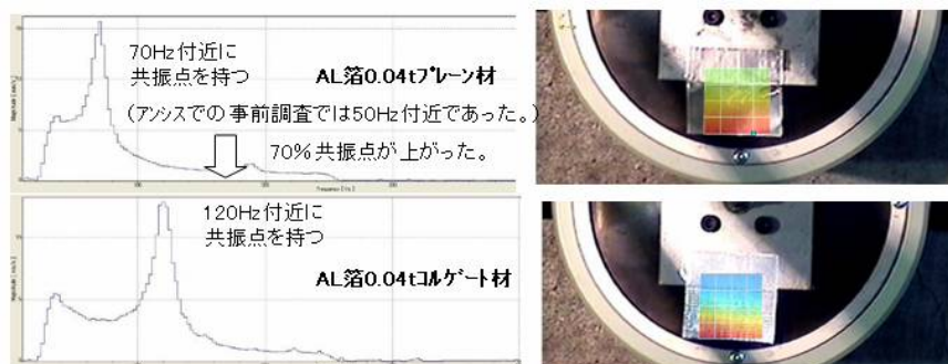
図 Al 0.04mm 箔材、コルゲート材の共振法による剛性向上効果比較
