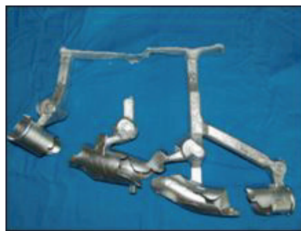
図 2-1-4 ガス加熱による鋳造品
