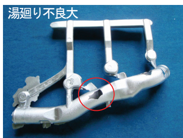
図 2-1-10 TRY#1 鑄造試験品
