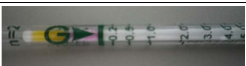
図 2-2-2. ガス検知管を用いた N_2O 濃度検査
