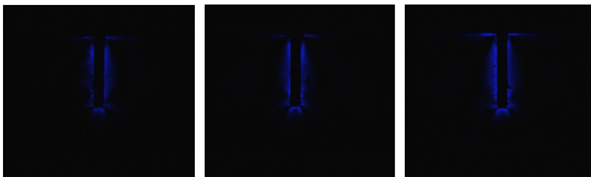
図6 溝加工した試料の漏れ光の観察例
