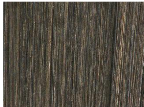
図 2-1-2-2 未投射メタルソー表面
