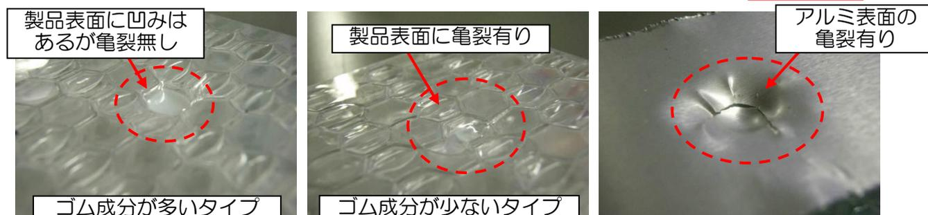
図 4-3 衝撃試験後の試験片写真
