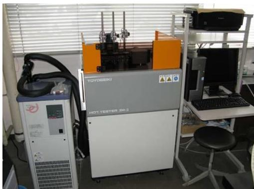
図 4-1 熱変形温度測定装置
