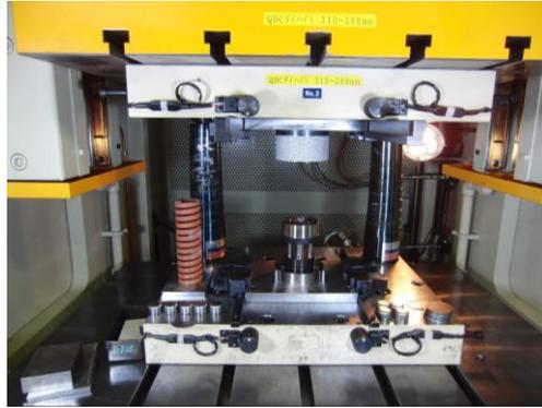
図5 バネによる偏芯荷重の負荷
