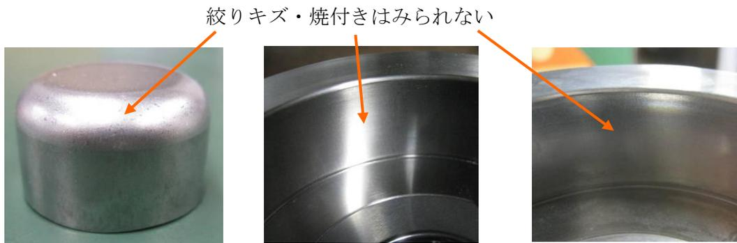
バネによる偏芯荷重を与えながら加工した製品(左)と金型(中、右)
