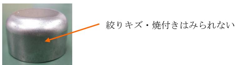
図7 バネによる偏芯荷重を負荷して加工した製品
