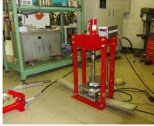
図 1 2 ハンドプレスを改造し計装化したカイドポスト加圧試験機
