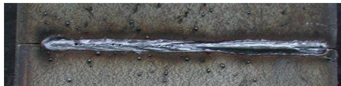
図 3-3-1 (2) a レーザ先行の溶接ビード
