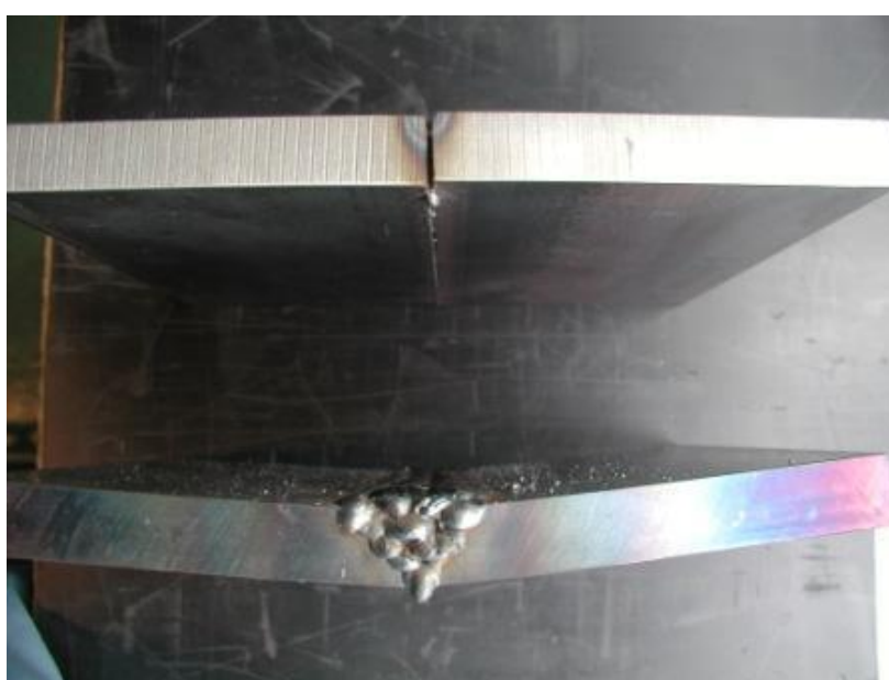
図3-3-2 (2) レーザハイブリット振動溶接法と従来溶接法
