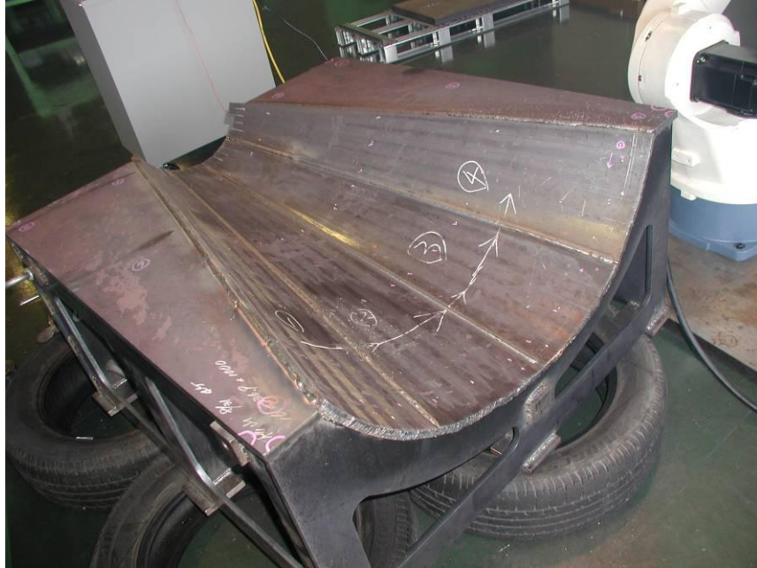
図2-3-2(1) レーザ・アークハイブリット溶接法によるダミー金型
