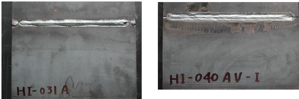
図 1-3 ④b ハイブリット振動溶接（表側）
