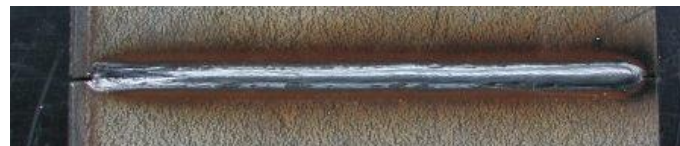
図 3-3-1 (2) b アーク先行の溶接ビード
