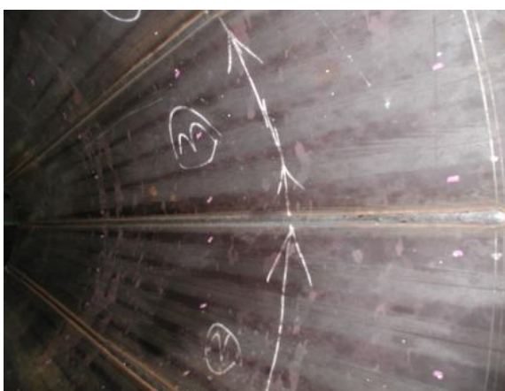
図 2-3-3 (3) ダミー金型の溶接ビードの比較
