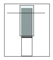
このスプライン軸とスリーブとのはめ合わせを確認するため、非破壊によるX線C T分析を行い、またはめ合わせた状態でエポキシ系の硬化剤で固着させ、左図のように切断し、その断面観察を行った。なお、観察試料はNo.1: スリーブ最大押込み力12N (軽く動く)とNo.4: スリーブ最大押込み力70N (手で力一杯の抵抗)の2 種類を観察し、それぞれを下記に示す。
