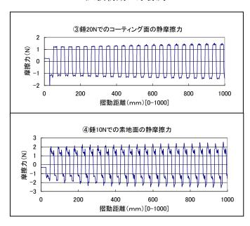
試験開始直後の摩擦力を上記に示す。ここで示される摩擦力は動摩擦力を測定しているが、開始直後であることから静摩擦力に近いものと考え、それぞれの比較を行った。図において、往復駆動時に生じる摩擦力は+側、-側に生じており、①から④の条件で平均的な摩擦力と摩擦係数は下記の表に示すとおりであった。
