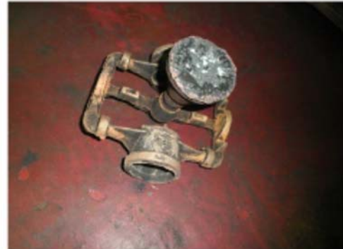
図1 1 試験注湯結果 (13mm ロング下ケース)
