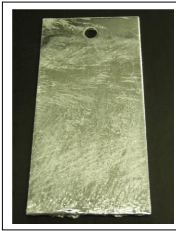
めっき加工後すぐの表面状態
