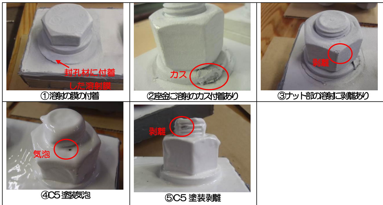
写真-38 各試験体における外観状態
