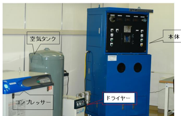
写真-42 荒田式ブラストエロージョン試験機の外観
