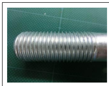
写真-24 ボルトめっき外観
