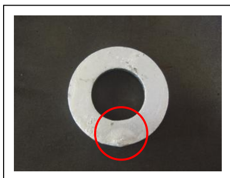
写真-18 座金（めっき溜り）
