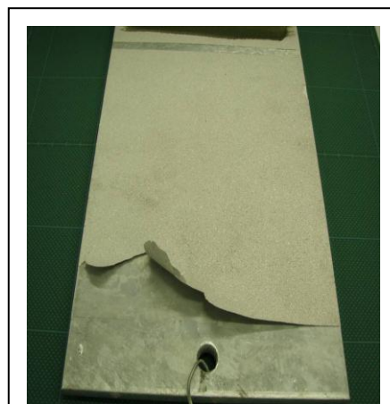
写真-1 従来の溶融亜鉛めっきへの溶射
