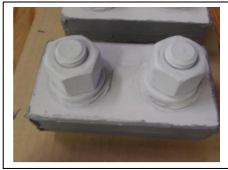
溶射後のボルト・ナット
