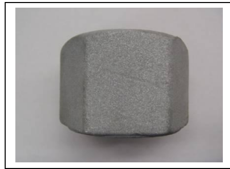
めっき皮膜へのブラスト状態 (ボルトネジ) めっき皮膜へのブラスト状態 (ナット)
