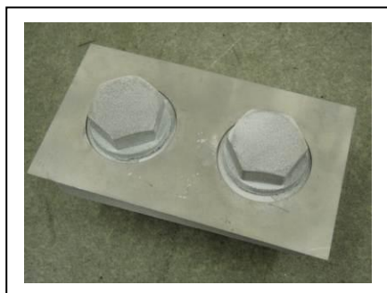
ステンレス鋼板によるマスキング
