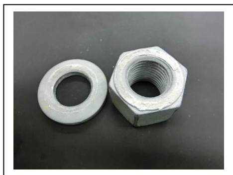
写真-27 120° 回転施工後の ナットと座金の接合面
