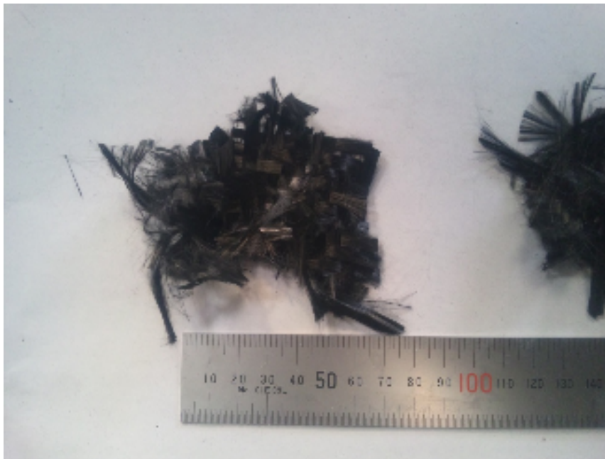
図8 直交する2方向で2回切断した再生炭素繊維クロス織物
