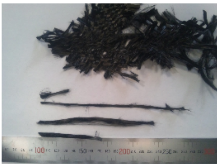
図4 切断済み再生炭素繊維クロス織物。設定長の3倍に切断された繊維が認められる。
