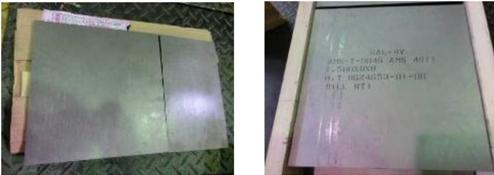
図 3.2.5 使用した被削材 Ti-6Al-4V
