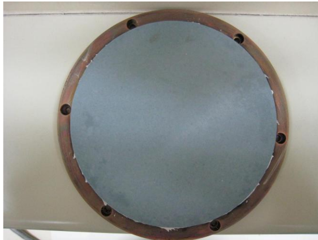
図 4-3 直径 6 インチ 23-KT 焼結体ターゲット
