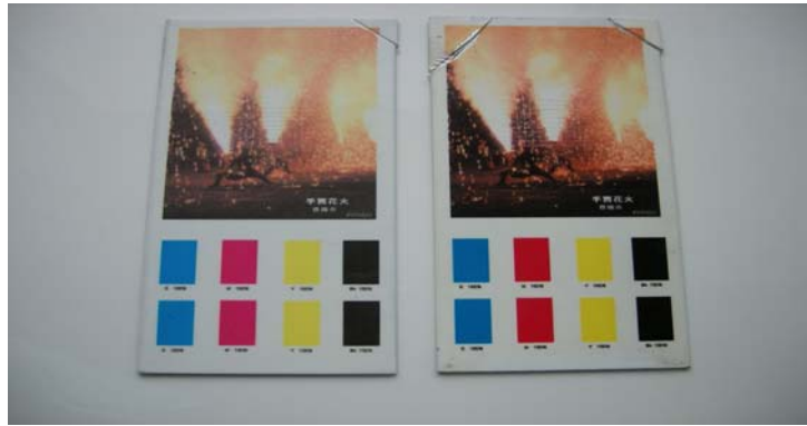
左：試験前 右：WOM 3,000hr 後に耐水性評価 碁盤目試験 100/100(中央上部) 碁盤目試験 100/100 (中央上部) 図 2-4-1-5 EB 塗膜の耐水性評価 (インクジェット印刷上に EB 塗料を塗布)
