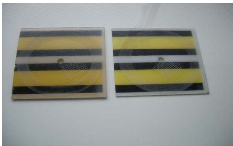
図 2-4-1-2 PET 素材上の耐久性 EB コートの促進耐候性試験後の耐摩耗性試験
