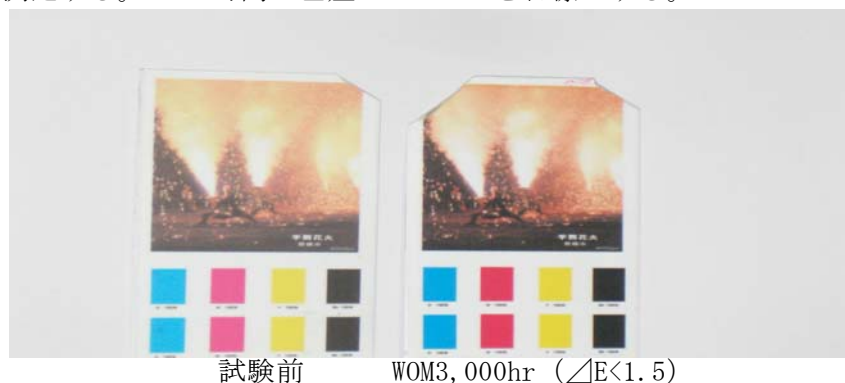
図 2-4-1-1 サンシャインウェザーメーターによる促進耐候性試験
