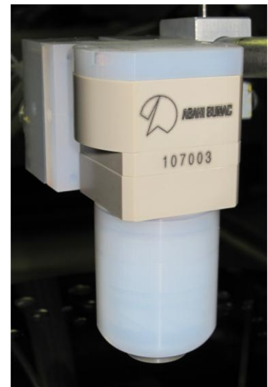
図 2.4 開発した回転霧化式エアロゾルスプレーノズル
