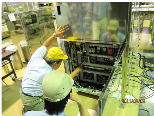
図4.1 第三者機関でSEMI S2, S8、EMC試験の審査を受審している様子
