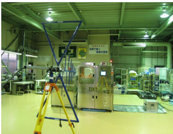
図4.1 第三者機関でSEMI S2, S8、EMC試験の審査を受審している様子
