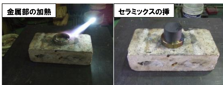
図 3-1-(9) 炭化ホウ素セラミックス-金属の接合(焼き嵌め)
