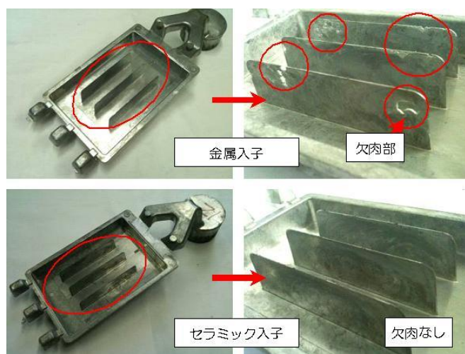
図 7-2-(5) ハイブリッド金型により作製したモデル形状(薄肉部)
