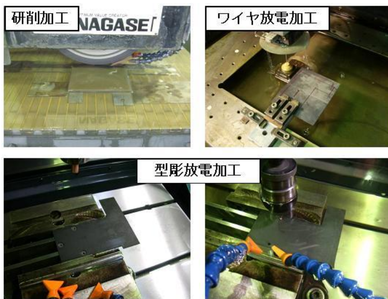
図 4-1-(2) 検証用形状の加工工程
