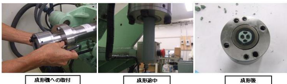
図 4-2-(8) ハイブリッド金型による押し出し成形
