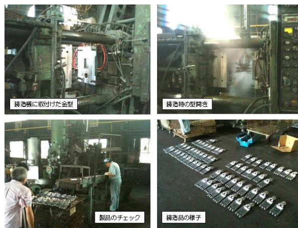
図 7-2-(3) ダイキャスト金型を用いた鋳造工程
