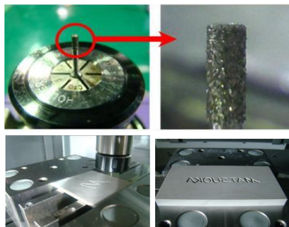
図 7-1-(7) 高精度・仕上げ加工(微細)時の工具と加工外観
