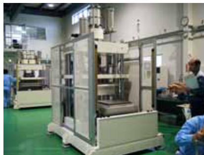
(a) 歪み修正炉の全景
