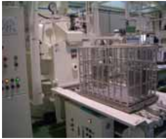
(a) 真空熱処理炉 (株) IHI 工番 V568100 型式 VGB-242436
