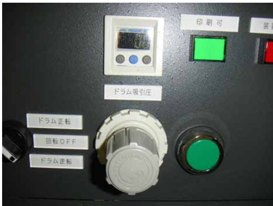
写真7 ドラム吸引力調整機能
