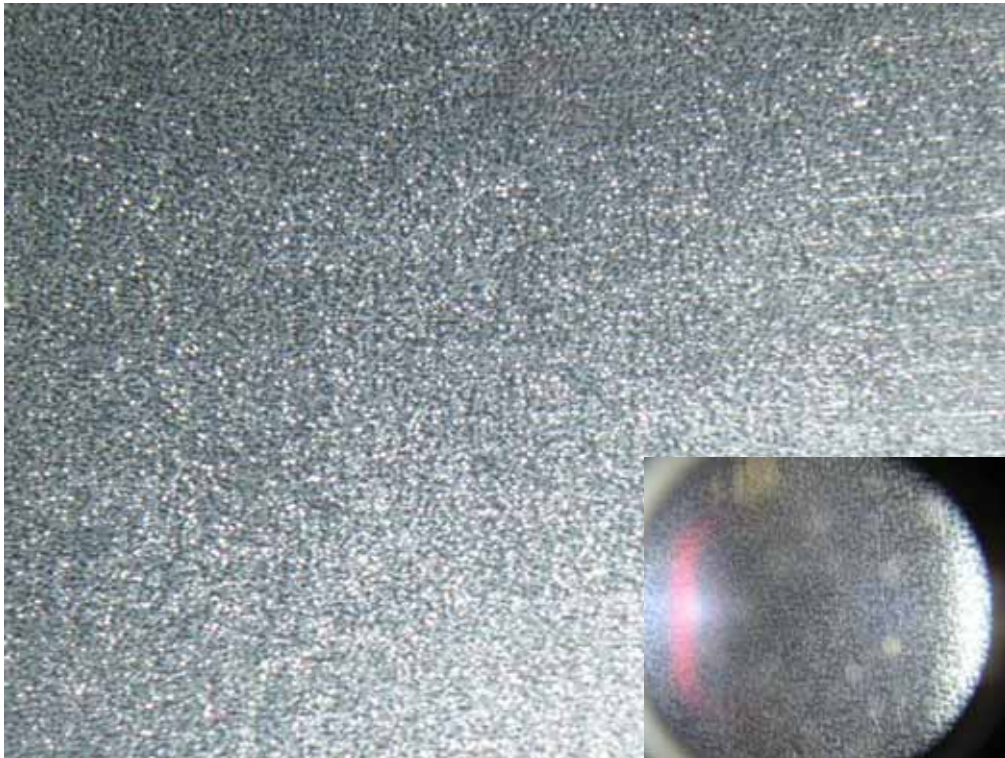
写真9 若干インクを厚めにした微細柄を転写したもの（インクの割れなし）
