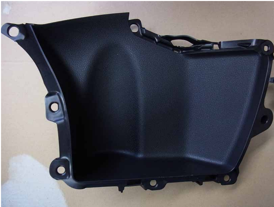
写真15 複数画像同時印刷したフィルムでしば加工したもの
