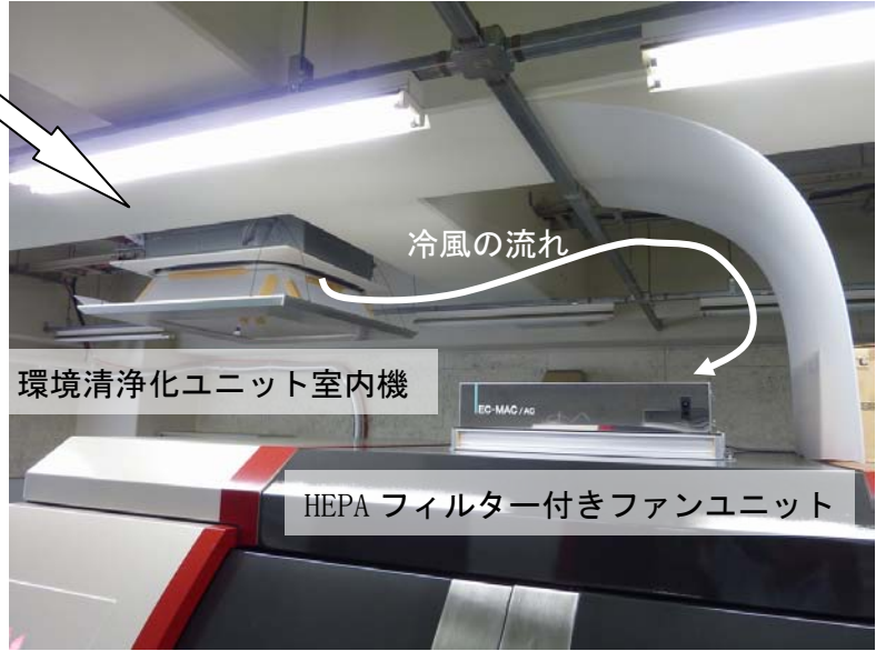
写真 2.2 ピコ秒レーザー加工環境清浄化装置
