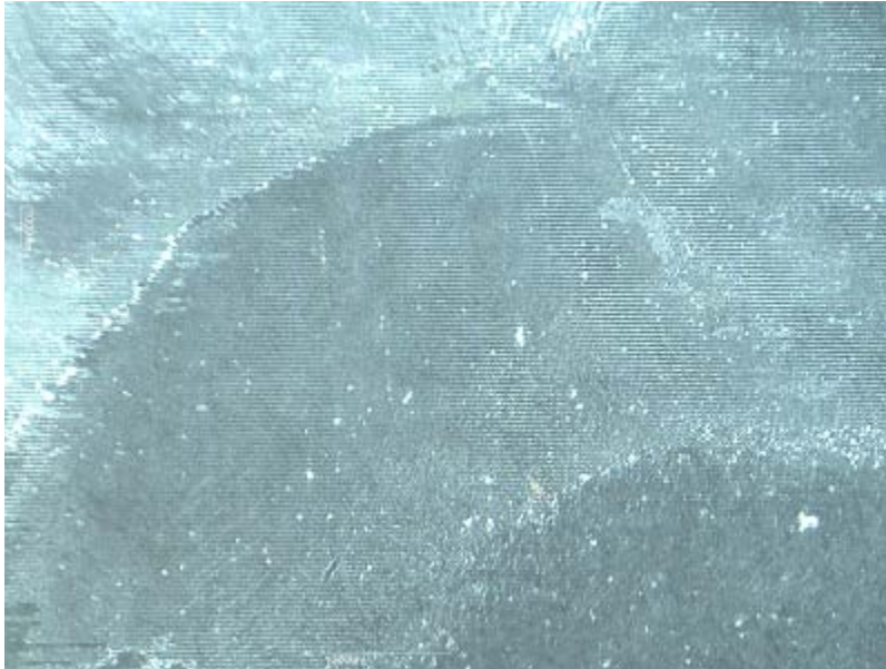
写真 2.24 PMMA 上に転写成形した V 字凸パターン (倍率 : \times 20 ) .
