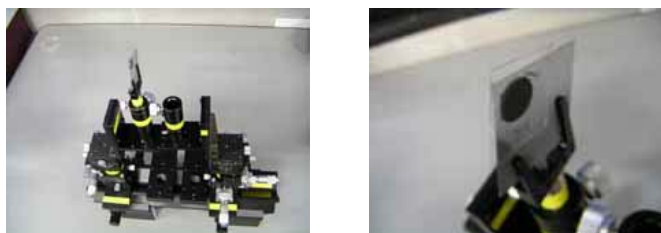
写真 2.8 レプリカ作製用治具の写真(左図:外観、右図:試料保持部拡大)
