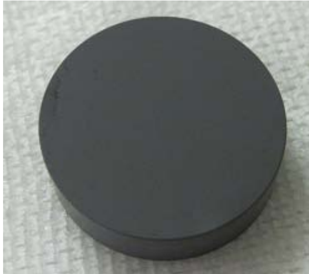
写真 2.14 多次元パターン形成用 SiC 素材。
