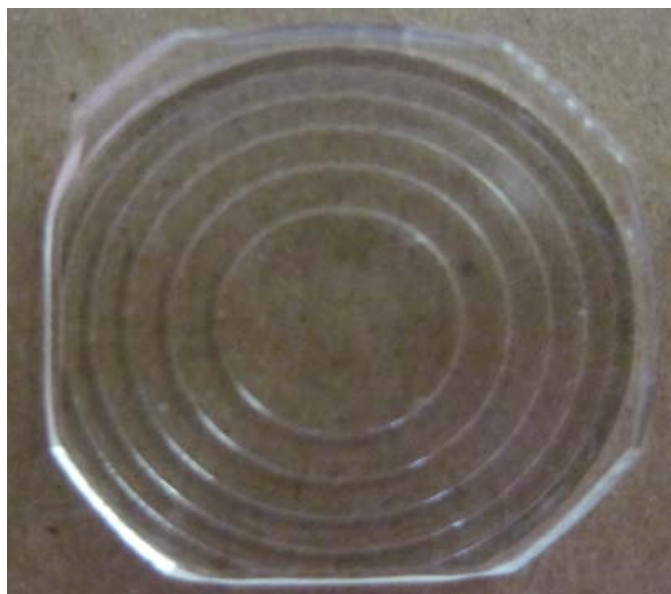
写真 2.22 転写成形した PMMA レンズ
