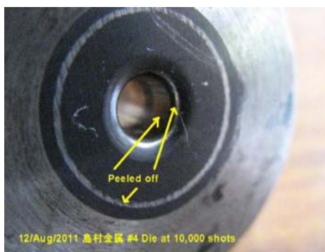
写真 2.3.3: 第4絞りダイ 10,000 ショット目。 R部奥とストレート部全深さにかけて剥離。
