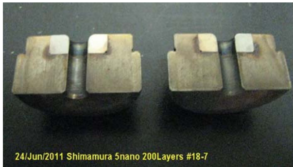
写真 1.2.3.4: Φ4 小径ダイ2個割り
