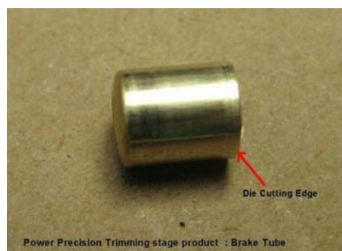
写真 2.2.2: 製品 トリミング後
