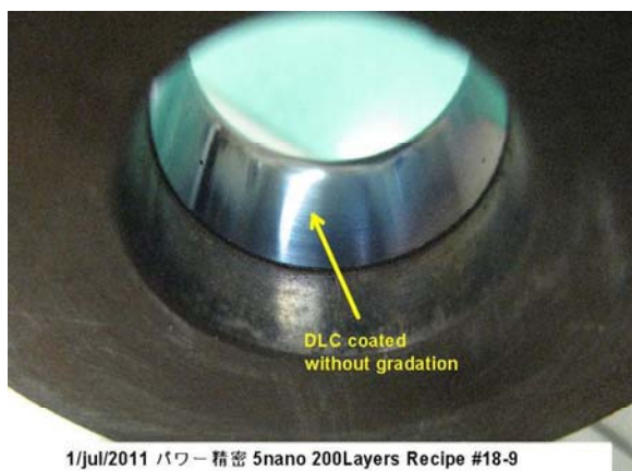
写真 1.2.2.1: 成膜直後のダイ内径
