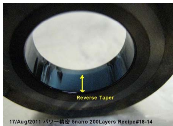
写真 1.2.3.6: ダイ#2、逆テーパ型 逆テーパ部へも濃青色で成膜。
