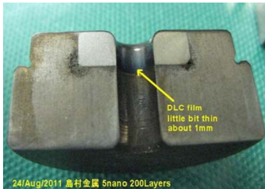
写真 1.2.3.7:WC 内壁成膜状況 最深部に濃青色が見えるがピンセット こすりでも傷痕付かない。
