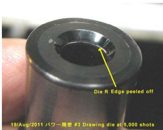
写真 2.2.3: 第3絞りダイ 5,000 ショット目。 滑り込みエッジ部全周に剥離が始まる。
