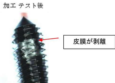
写真 2.1.6 タップ加工テスト後
