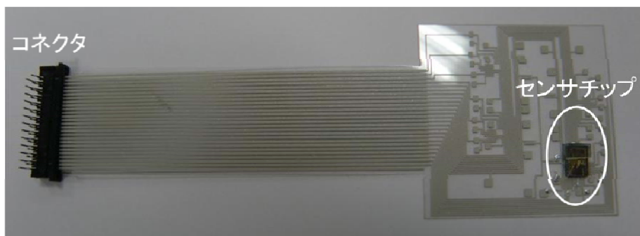
図 2-2-3 表面実装型センサを搭載したフレキシブル基板
