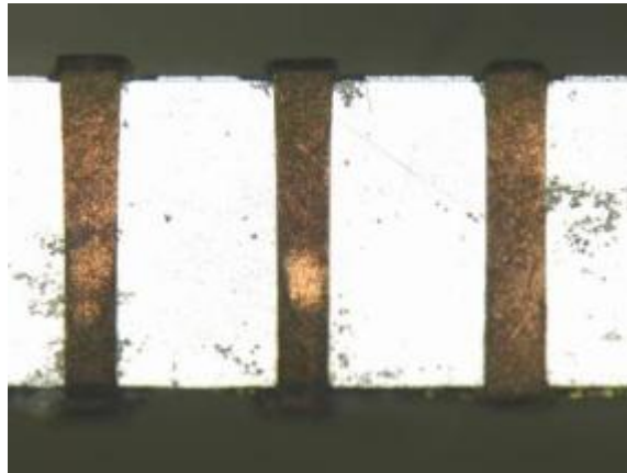
図 2-1-1 TSV の断面写真
