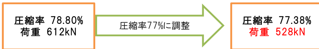
図-33 最終配合 (試作-5 S : 静電型) の試験結果 (300℃)
