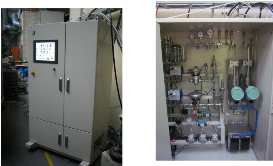
図2-8 新ウォームスプレー制御盤外観写真
