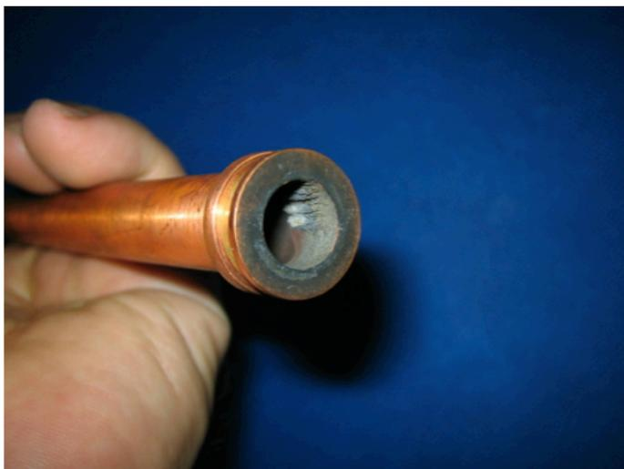
図 2-1 3 10inch バレル閉塞現象 (材料: Ti)
