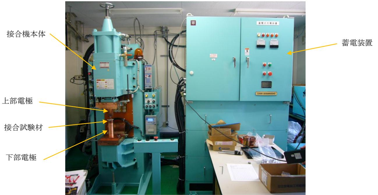
写真 2.1 固相拡散接合機－ 2
