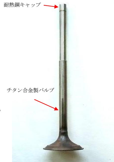
写真 1.9 試作チタン合金バルブ
