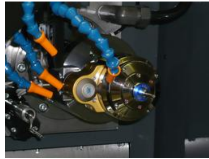
改造により主軸に取付け可能となった高速スピンドル
