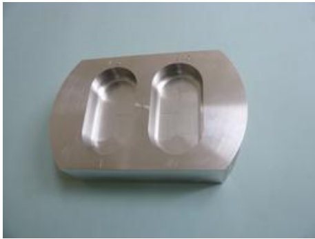
写真 4-2-8 マグネシウム合金 ニアドライ加工
