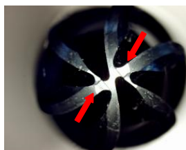
試作した特殊エンドミル先端(左:6枚刃、右:4枚刃) ※矢印部分が無刃部分
