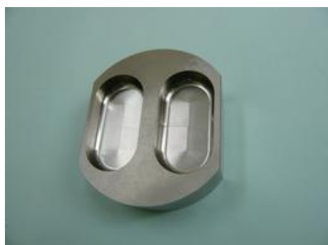
写真 4-2-1 インコネル ニアドライ加工
