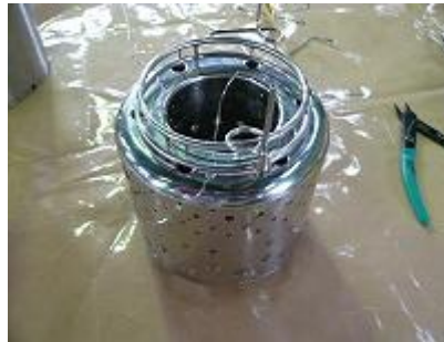
④燃料配管組付け
