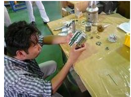
④燃焼筒確認
